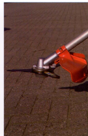
Links zit de beschermkap te hoog. Rechts zit de beschermkap goed.
