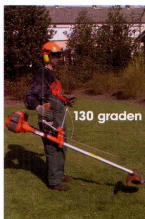
Juiste houding en draagwijze. Links zijaanzicht, rechts vooraanzicht.
